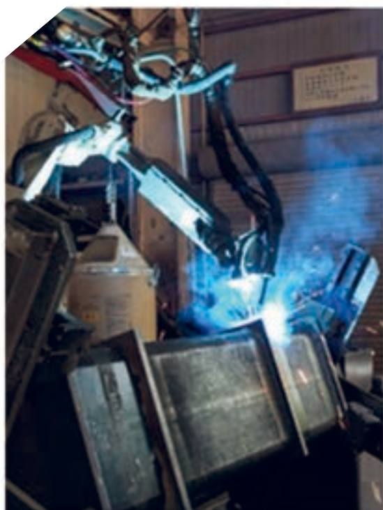
【鉄骨コア（サイコロ）連結溶接ロボットシステム】 Connected welding robot system】
